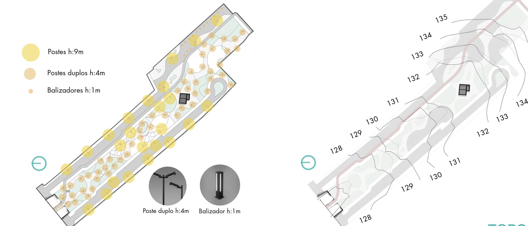
Nas vias, foram mantidos os postes existentes de 9 m, com posteamento unilateral, suficiente para a largura padrão, além de complementação bilateral nos trechos mais amplos. No interior do parque, foram instalados postes duplos de 4 m ao longo dos caminhos e postes simples de 9 m nas áreas de estar, como o playground, o espaço pet e a academia ao ar livre. Balizadores reforçam a iluminação na rua compartilhada e sob o viaduto.
