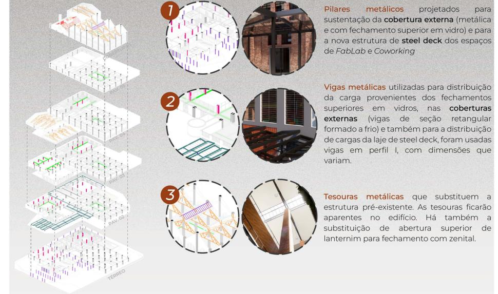
**Pilares metálicos** projetados para sustentação da **cobertura externa** (metálica e com fechamento superior em vidro) e para a nova estrutura de **steel deck** dos espaços de FabLab e Coworking.
