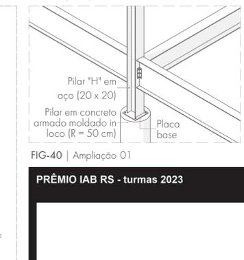
FIG-40 | Ampliação 01
