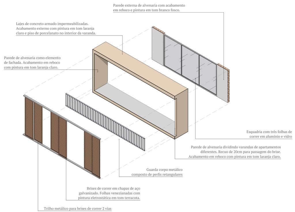
isométrica explodida elemento de fachada | sem escala
