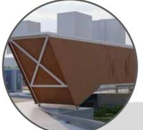
A estrutura metálica, com módulos de pilares em perfil I e treliças inclinadas, oferece robustez e estabilidade, enquanto o núcleo de concreto proporciona apoio adicional, garantindo resistência e eficiência no projeto.
