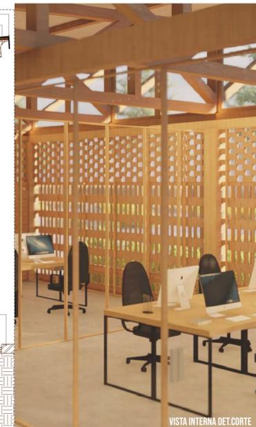
Fechamentos laterais mesclam parede cobogó de tijolo maciço garantindo iluminação e ventilação natural, além de compor esteticamente os ambientes.
