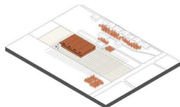
**Definir altura padrão** do pavilhão, utilizar shed para iluminação natural modulados de 18M.
