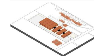
**Conectar os volumes e demarcar a circulação** através de uma cobertura com telha translúcida e bambu gerando um jogo de luz esmaltada nos espaços de circulação.
