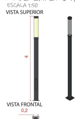
MATERIAL: Alumínio, iluminação em LED, chumbada com parabol.
