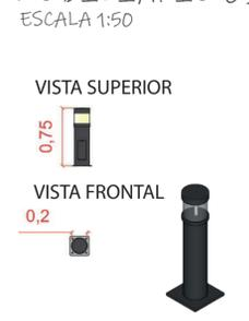
MATERIAL: Corpo de aço steel, iluminação em LED, chumbada com parabol.
