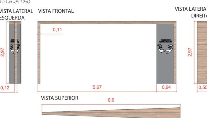
MATERIAL: Painel de alumínio sobre estrutura metálica.
