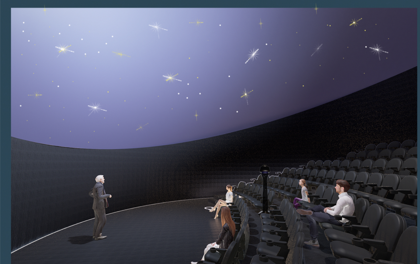
O AUDITÓRIO PLANETÁRIO Para o projeto, foi proposto uma cúpula esférica inteira de 17m de diâmetro externo, já no seu interior a semi-esfera inclinada detém o diâmetro de 14m estando classificado como um planetário de tamanho médio com capacidade de até 100 lugares.
