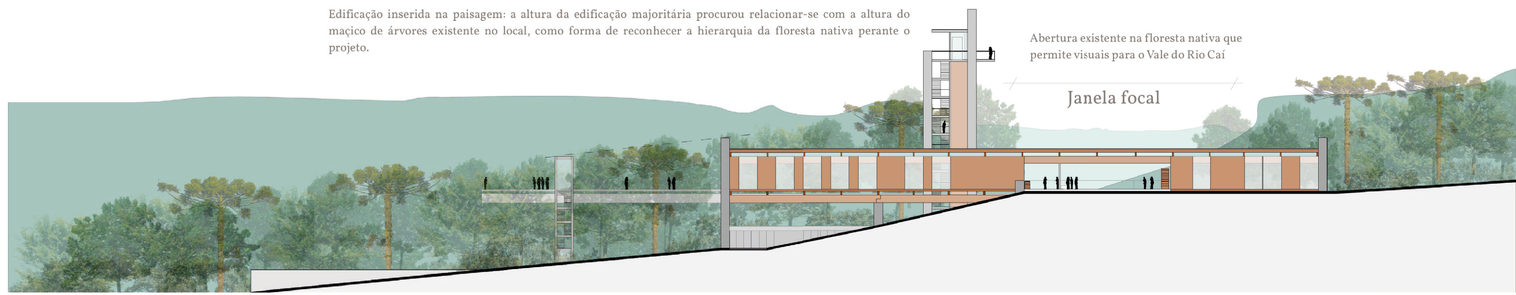
FACHADA SUDOESTE A proporção de cheios e vazios da Fachada Sudoeste é embasada por estudos das proporções da casa imigrante italiana, muito presente no bairro Linha Nova. Este estudo revelou que os vazios apresentam sempre dimensões fixas (esquadradas de madeira) e os cheios variam conforme a necessidade dos ambientes internos. Dessa forma, foi feita uma releitura deste ritmo por meio de planos de madeira e de vidro. Além disso, constatou-se também a proporção de 3:4 dos vazios, o que também foi incorporado à fachada do Esporo como forma de relacionar-se com a arquitetura presente na vizinhança.
