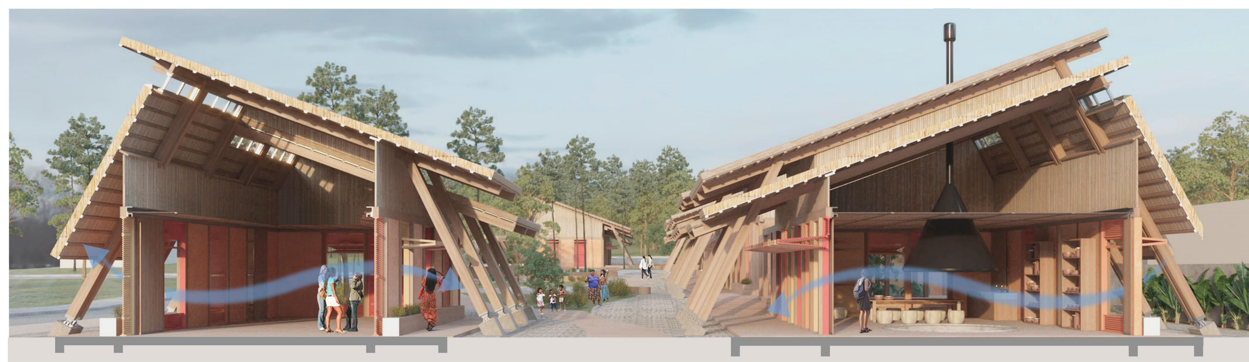
Corte detalhando setor administrativo (A) e setor de alimentos (B). Destaque para a estratégia para obter conforto térmico através da ventilação cruzada . Além disso, encaminhamento para visuais a mata nativa (percurso à mata) e forro retrátil aberto no setor administrativo (A) e fechado no setor de alimentos (B).
