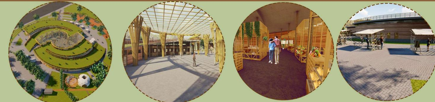
O elemento central é feito com vigas e estrutura de pilares de bambu, que tem volumetria inspirada no padrão dos troncos das árvores. A cobertura central é feita com módulos fotovoltaicos semitransparentes, servindo para a geração de energia no local.
