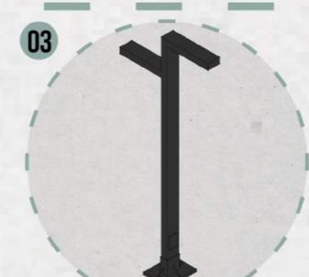
[POSTE DE LUZ] Poste em aço galvanizado com raio de 5m e lâmpadas de LED 150W e 100W
