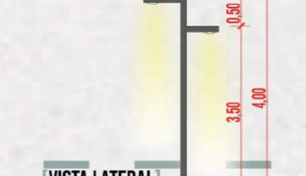
[POSTE DE LUZ] Poste em aço galvanizado com raio de 5m e lâmpadas de LED 150W e 100W
