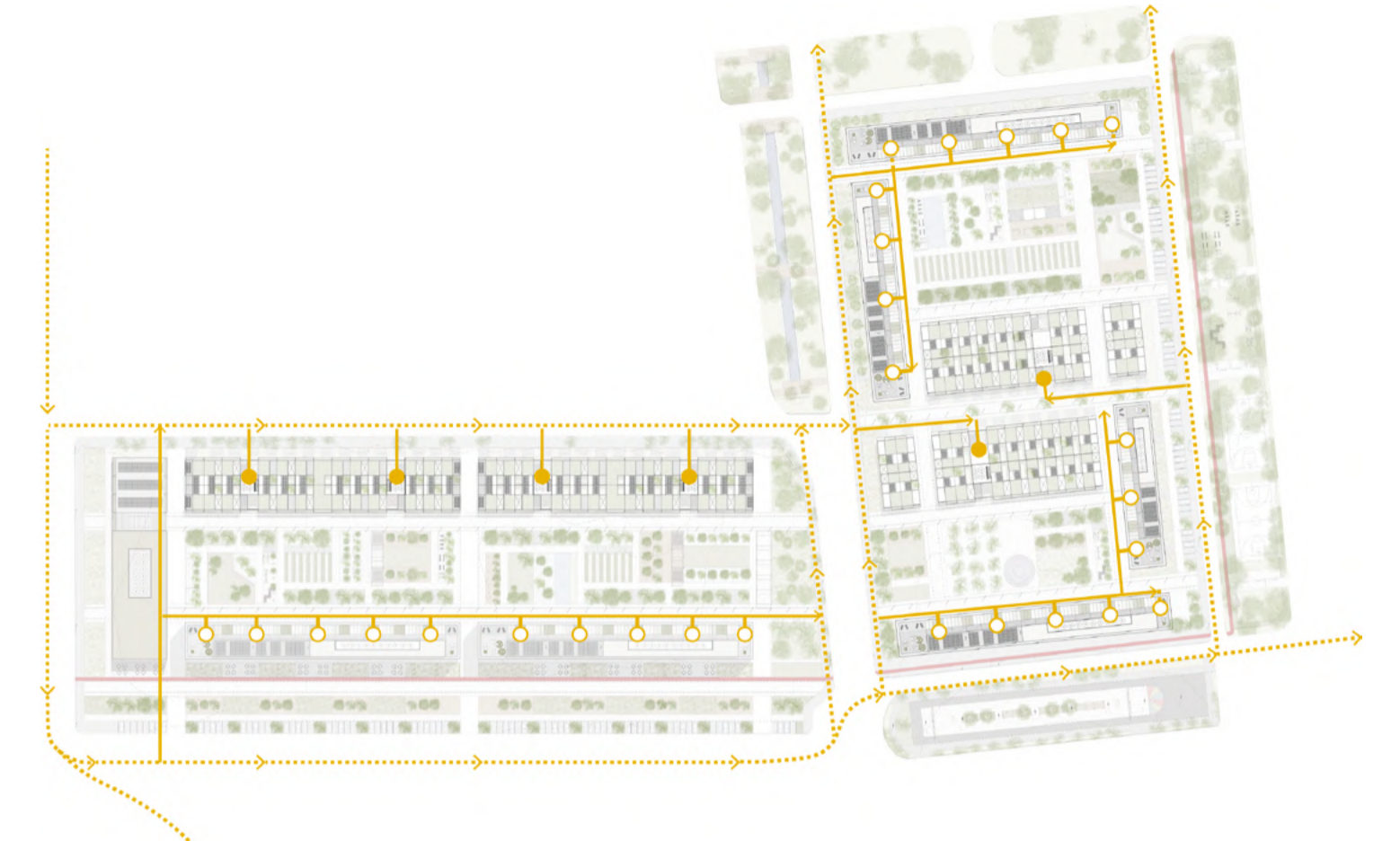
FIG. 24 diagrama de abastecimento de luz A extensão pública da iluminação e energia do projeto tem entrada no módulo unifamiliar de área condominial e a partir daí, estende-se pela implantação subterraneamente até os medidores das unidades.
