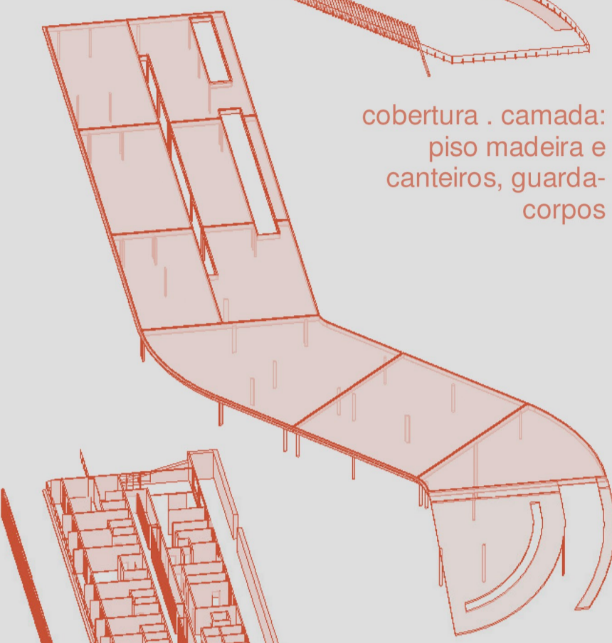
cobertura . camada: clarabóia, estrutura, laje nervurada, camada verde e contenções, laje maciça inclinada c/ vigas e pilares
