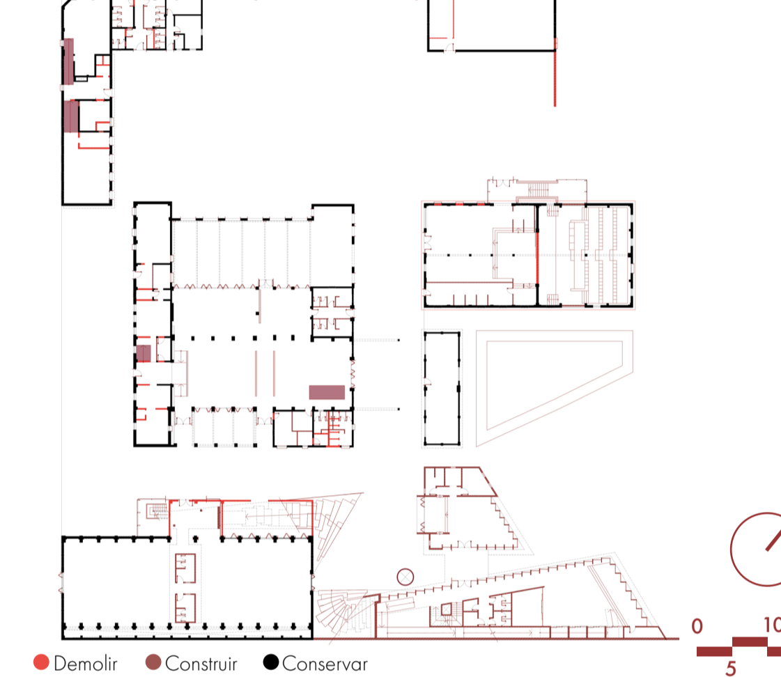
Planta Demolir/Construir/Conservar Pav. Térreo
