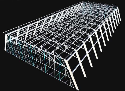
Estrutura metálica em sistema pórtico, com pilares inclinados e treliça. Estrutura enxaimel das laterais fecham o pórtico dando estabilidade a forma. O enxaimel é um elemento estético e estrutural, alumínio com reforço em aço.
