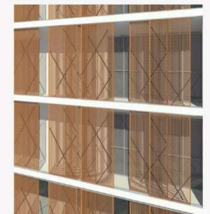
**Imagem 03** - Os brises utilizados são móveis, baseada na linha Sliding Screen da Hunter Douglas.
