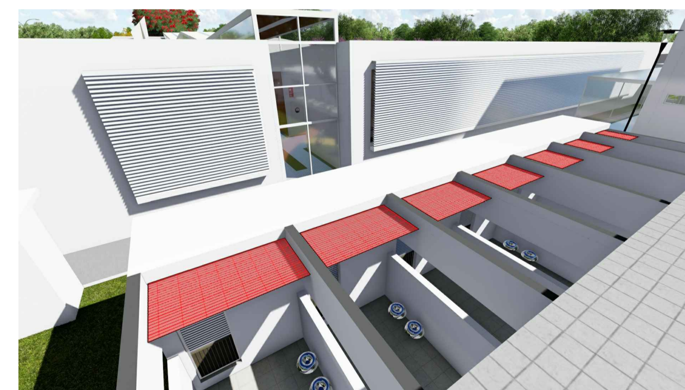
Sistema automatizado retrátil que compõe a cobertura do solário das baias.
