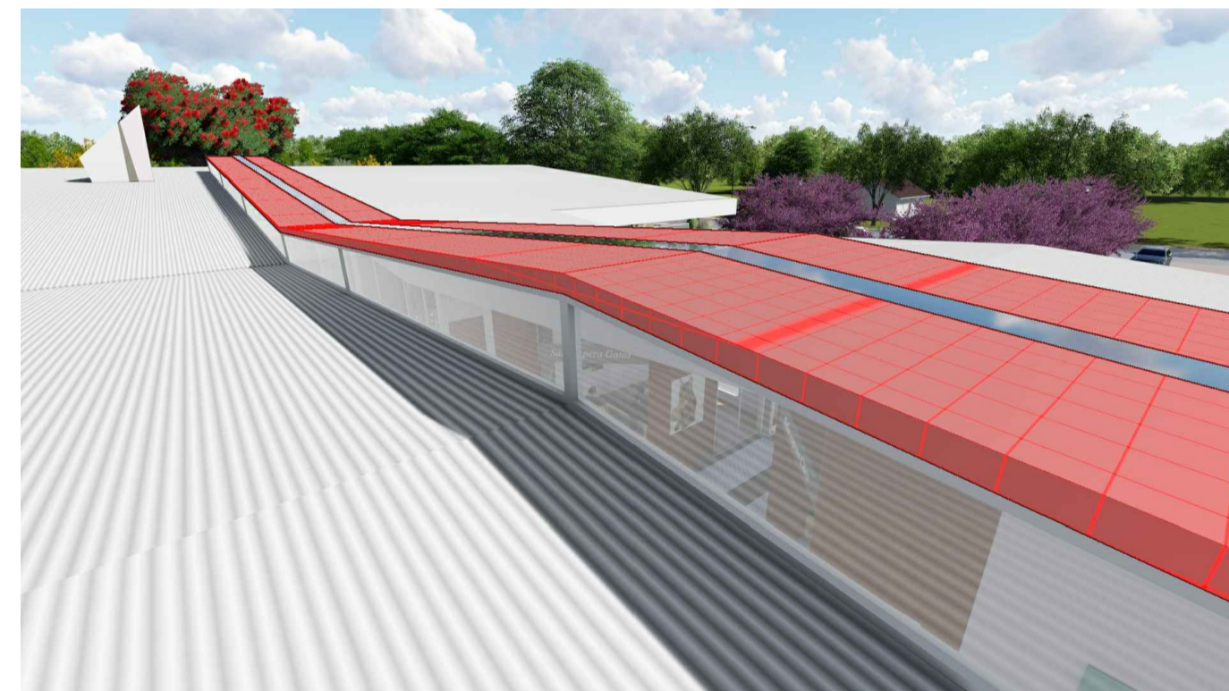
Claraboia instalada sob o corredor do bloco de serviços composto em estrutura metálica e vidro.
